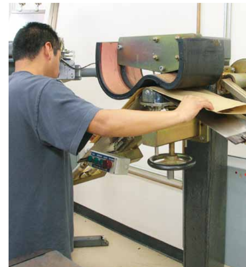
Gegenüberliegende Seite: Eine computergesteuerte Fräse bringt Präzision und Konsistenz in die Halsbearbeitung; darüber: Eine automatisierte Maschine zum Biegen der Zargen, die von der Taylor Werkzeugabteilung entworfen und gebaut wurde, erhöht die Effizienz und reduziert den Holzbruch
