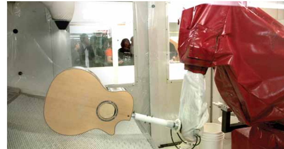
Gegenüberliegende Seite (v.l.n.r.): Eine Straße in Kamerun, von hier wird das Ebenholz bezogen; Ebenholzformling für ein Griffbrett aus dem Sägewerk Crelicam in Kamerun, dessen Miteigentümer Taylor seit kurzem ist; diese Seite (v.o.n.u.): Taylors umweltfreundliches Polyester-Gitarren-Finish wird mit Hilfe eines kombinierten Spraysystems auf Roboter- und elektrostatischer Basis aufgetragen, was die Abfallstoffe drastisch reduziert; ein Stapel gefrästes Mahagoni für Gitarrenhänse
