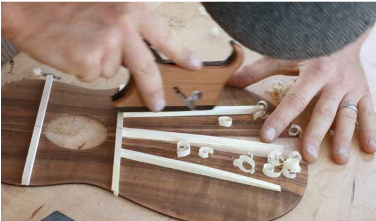
Andy Powers schabt mit Hilfe eines Nuthobels Streben für die Deckenbeleistung auf Größe. „Ich gehe bei der Bearbeitung langsam vor, von einer Leiste zur nächsten, bis sie sich ihrer Endgröße annähern, und überprüfe immer wieder den Klang der Decke“, erklärt er. „Ich habe mir diesen Hobel an meinem 13. Geburtstag gebaut und seither bei fast jeder von mir gefertigten Gitarre verwendet.“
