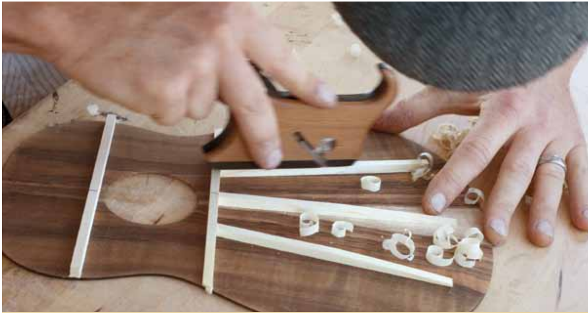
Andy Powers cepilla las varetas de un ukelele con un garlopín para rebajarlas y comenzar a conformar la sonoridad de la tapa. “Las iré trabajando lentamente, una a una, hasta darles su tamaño final y controlando el sonido de la tapa conforme voy avanzando”, explica. “Fabricué ese garlopín en mi decimotercer cumpleaños y lo he usado prácticamente en todas las guitarras que he construido desde entonces.
