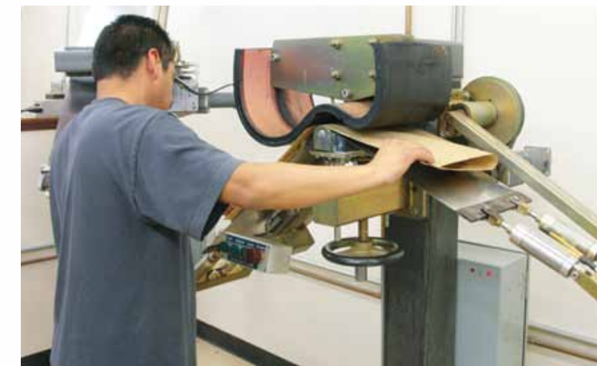
Página opuesta: El control computarizado aporta precisión y homogeneidad al proceso de grabado del mástil. Arriba: Las máquinas automatizadas, diseñadas y fabricadas por el departamento de utillaje de Taylor aumentan la eficiencia y reducen las roturas de las maderas
