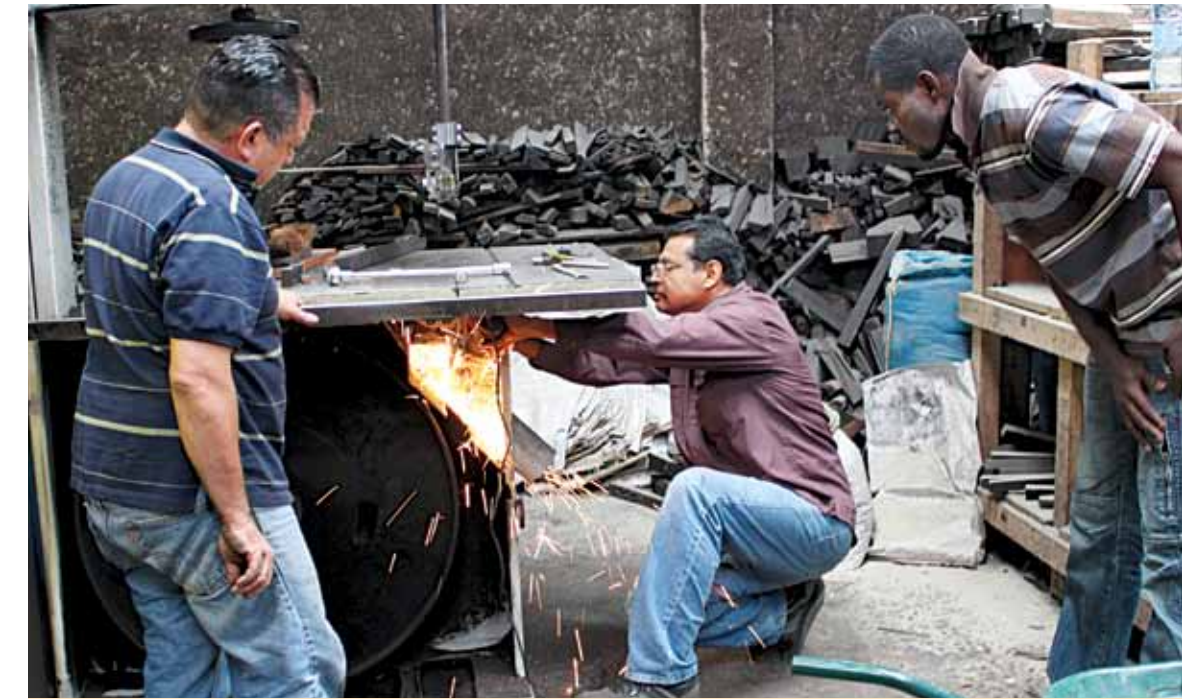
Arriba: Leandro Bailon (centro), empleado de la fábrica de Taylor en Tecate, instala una nueva guía en una sierra de cinta en el aserradero de Crelicam en Yaundé mientras Jesús Jurado (izquierda), de nuestra fábrica de los EUA, y el mecánico de Crelicam Vincent Lumpungu observan; Abajo (de izquierda a derecha): Los empleados de Crelicam Michel Awoa Onguene, Jean Mba Beka y Bekono Elono; Página opuesta (de izquierda a derecha): Empleados del aserradero de Crelicam en Yaundé: Franck Destin Oyie Owona y Jean Martial Owono
