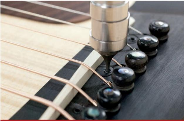
Tres tornillos tipo Allen permiten calibrar en el departamento de ensamblaje final Taylor la presión adecuada que cada sensor ejerce contra la cejilla. Una vez que las presiones se han establecido en la fábrica, no debería ser necesario realizar ningún otro ajuste a menos que se mueva o se sustituya la cejuela del puente.
