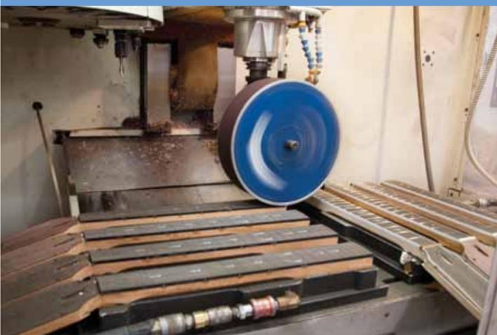
Un exemple des outils conçus par M.Guzzetta pour la fabrication des guitares. Ci-dessus : fixation à changement rapide pour cylindre de contact d'une ponceuse à commande numérique, qui permet de poncer suivant le radius de la touche ; ci-dessous de g. à dr. : plateau à succion, utilisé pour maintenir le corps d'une
