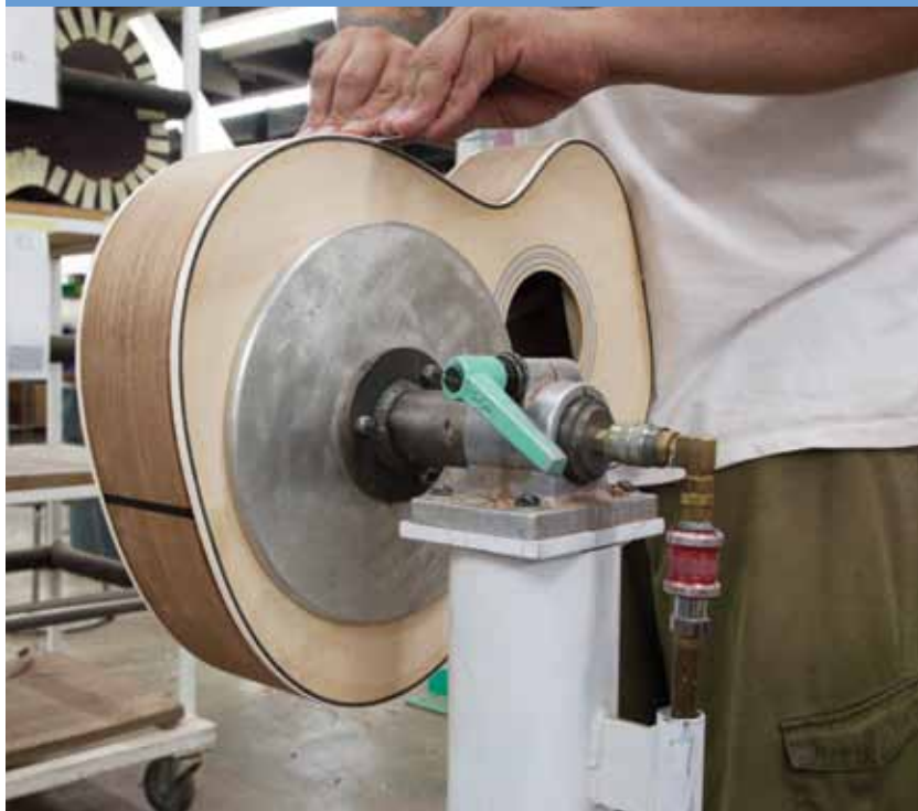
Abajo: Muestra de herramientas diseñadas por Guzzetta para la construcción de guitarras De izquierda a derecha: Un mandril de vacío, empleado para sujetar la caja de las guitarras sin dañar la superficie mientras se cepilla el
