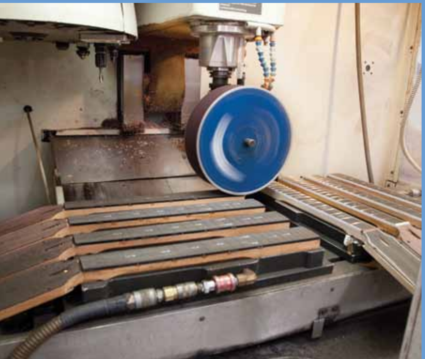
sobranje de los perfiles; un tambor de lijado de sustitución rápida para sierra de tipo CNC, que permite lijar el radio del diapasón; "fret buck", diseñado para absorber los impactos y proteger la guitarra cuando se incrustan los trastes en el diapason
