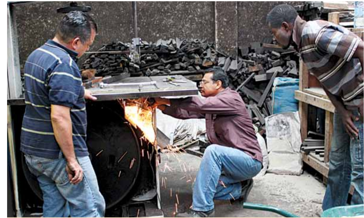
Oben: Taylors Leandro Bailon (Mitte) aus dem Taylor-Werk in Tecate bringt eine neue Sägebandführung an einer Bandsäge im Crelicam-Sägewerk in Yaoundé an. Jesus Jurado (links) aus unserer US-Manufaktur und der Mechaniker Vincent Lumpungu von Crelicam verfolgen aufmerksam seine Arbeit. Unten (L-R): Crelicam-Mitarbeiter Michel Awoa Onguene, Jean Mba Beka und Bekono Elono; Gegenüberliegende Seite (L-R): Mitarbeiter des Crelicam-Sägewerks in Yaoundé: Franck Destin Oyie Owona und Jean Martial Owona
