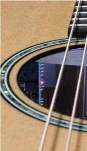
Indicador luminoso LED de la pila
