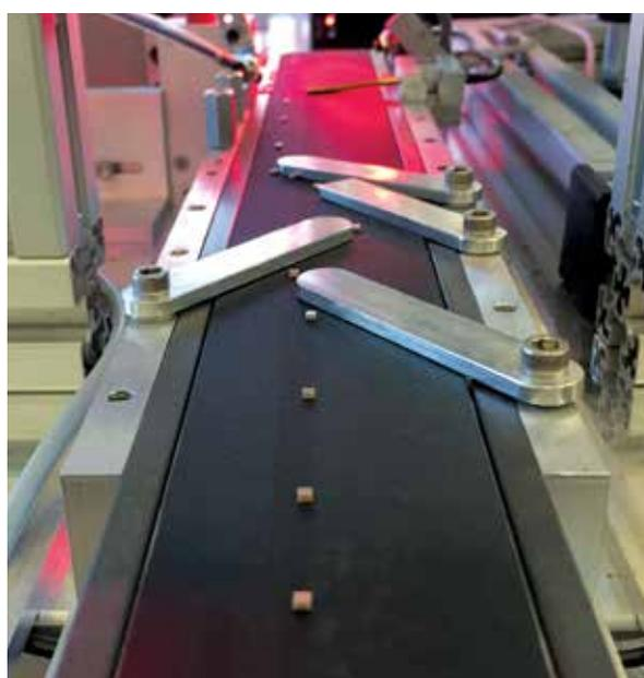
Cristales piezoeléctricos desplazándose hacia la estación de trabajo para que el sistema de visión computerizada los inspeccione.
