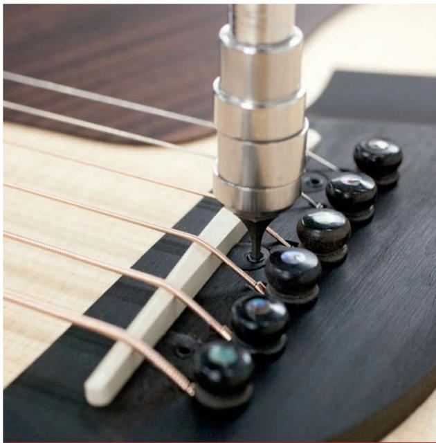
Trois vis Allen permettent au service assemblage final Taylor d'ajuster la pression de chaque capteur contre le sillet. Une fois la pression réglée à l'usine, aucun ajustement n'est a priori nécessaire, sauf en cas de déplacement ou de remplacement du sillet.
